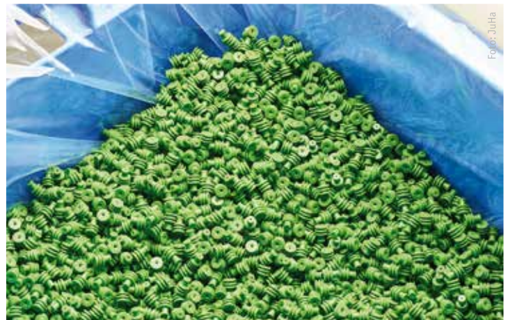
Die großen LSR-Werkzeuge mit bis zu 640 Nestern zur Produktion von Einzeladerabdichtungen (unten) bestehen aus solchen Grundbausteinen (oben).
