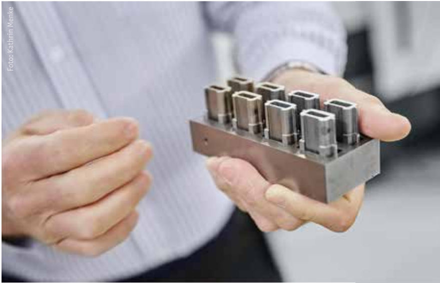
Konturnahe Kühlungen – im Block gefertigt und anschließend aufgelasert – bringen Zykluszeitverkürzungen von 20 bis 30 %.
